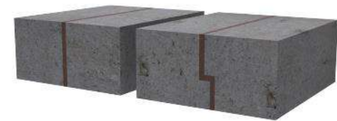
Juntas de dilatación
